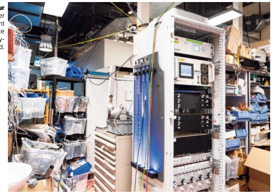
In de 'borrelbak' , buizen gevuld met paraffineolie, borrelt lucht uit de fermentatiekamer naar boven.
